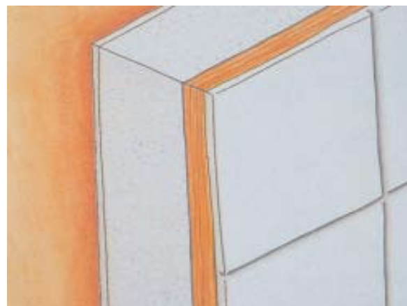
4 rétegű szendvicelem ragasztása Körapur 648 termékkel
